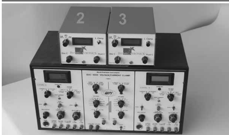
Comparaison entre le clamp électronique de WPI (1) à deux voies et le clamp Biomécatronics à une voie (2) et (3)
